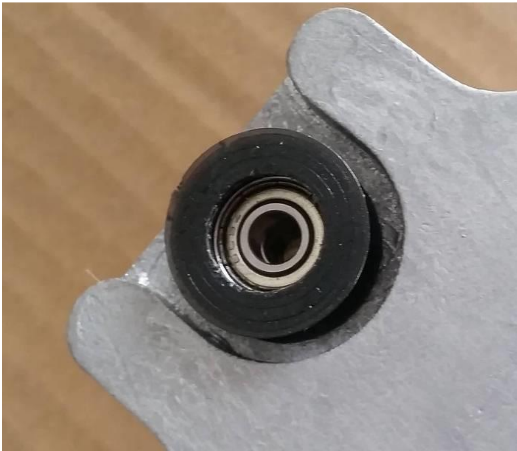
Ici le diamètre inférieur de la poulie et le 605z en fond.
