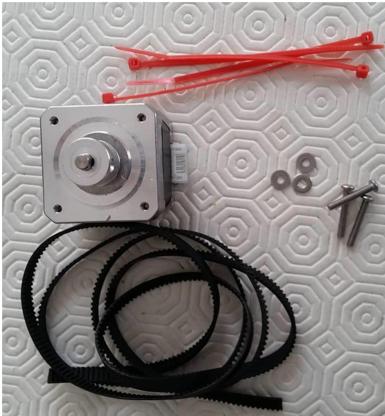
1 Moteur Nema 17 + sa poulie GT2, 1m de courroie 3 vis de 3*20 + 3 rondelles M3.
