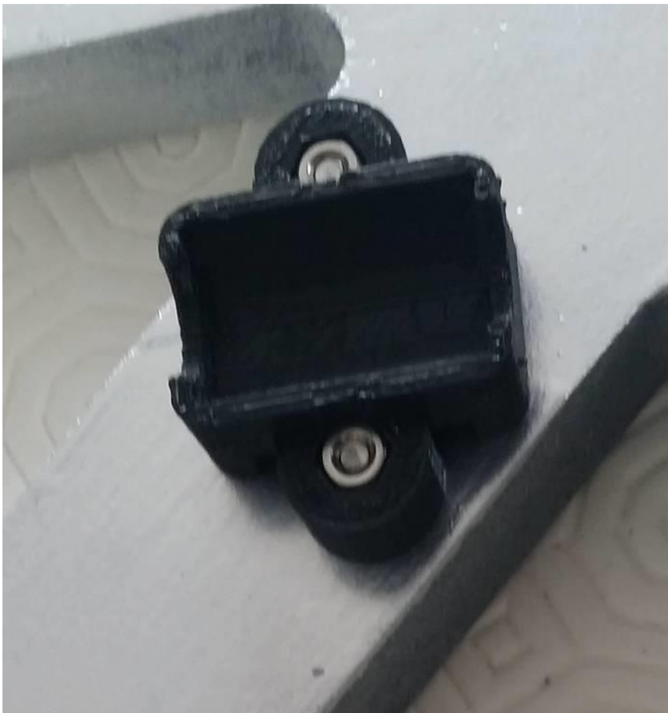
Fixer fermement les supports de LM8UU.
