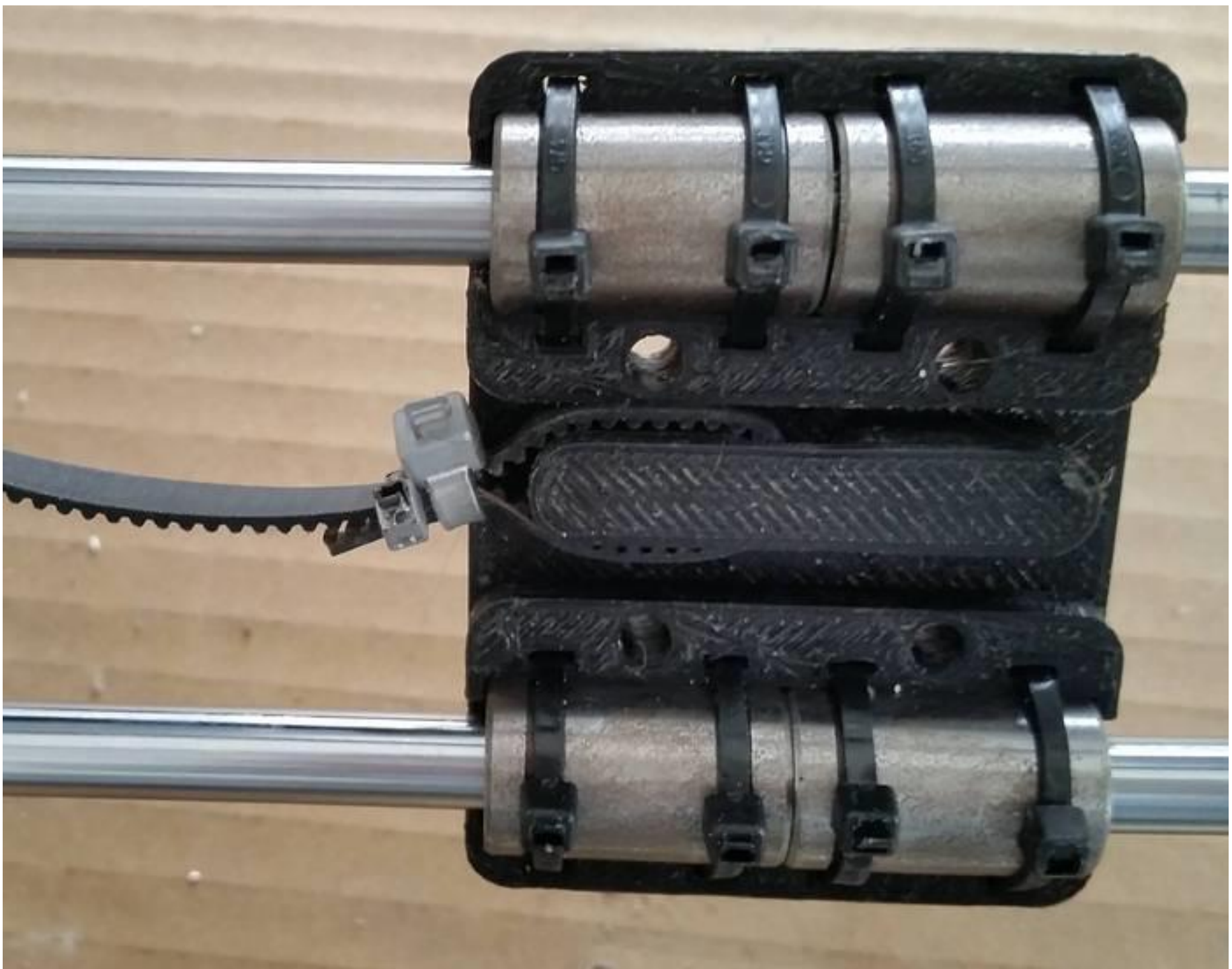
Passer la courroie et fixer avec 2 colsons.
