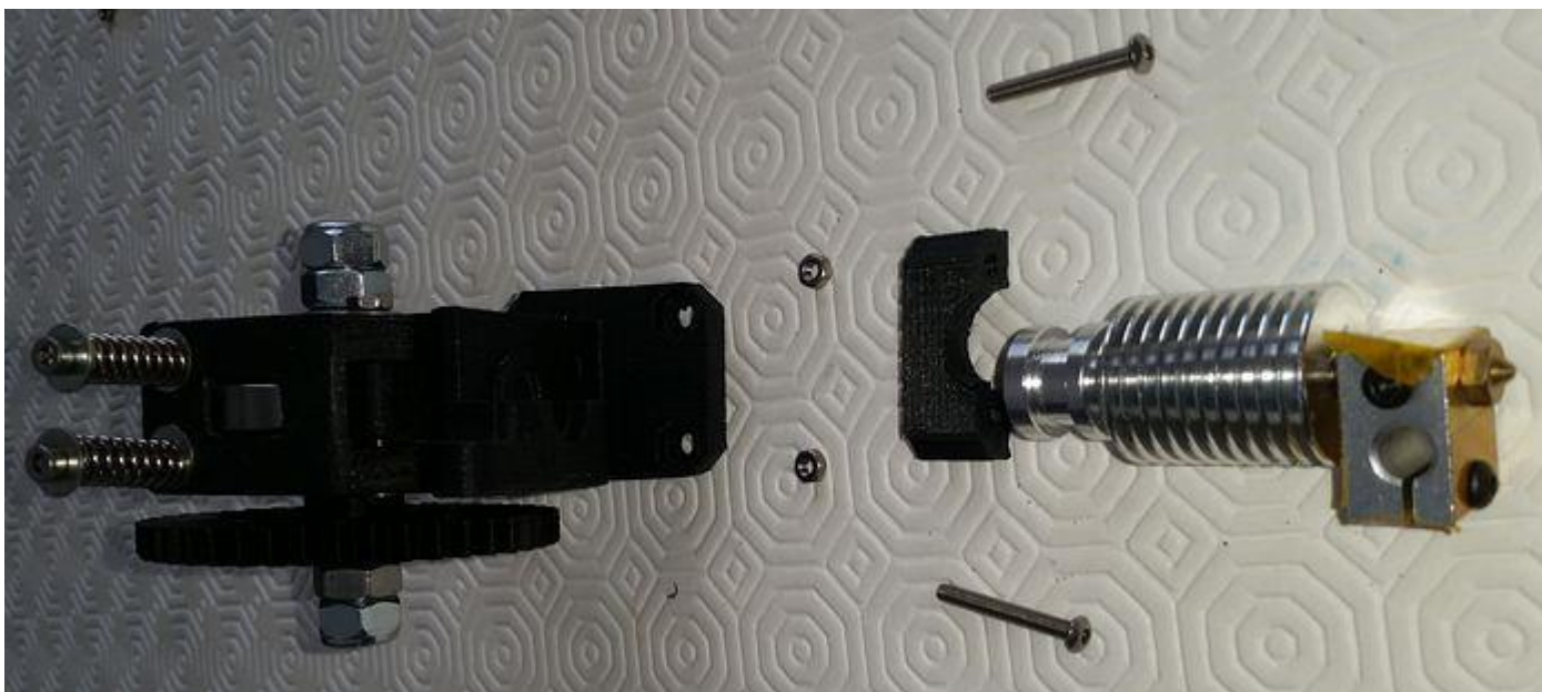
La pièce de fixation de hotend (Flange), 2 vis de 3*25 et 2 écrous de 3.
