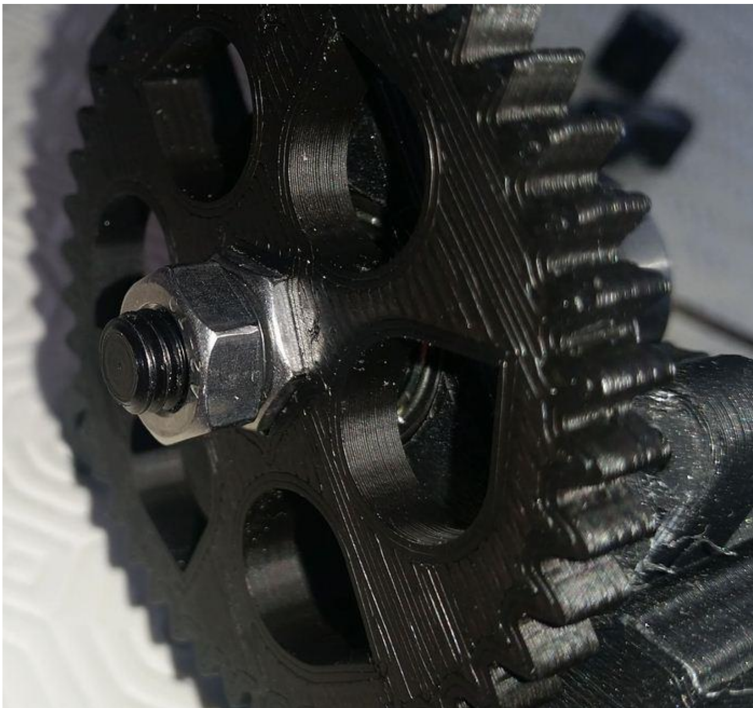
Visser un deuxième écrou sur la tige d'extrusion qui doit toucher l'autre écrou.
