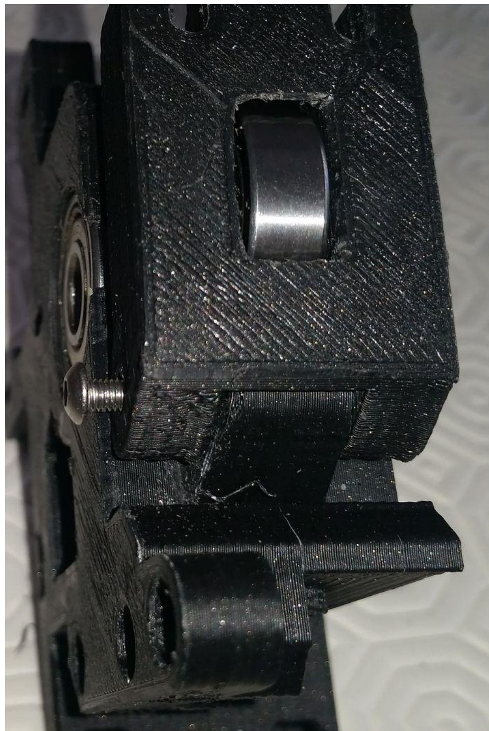
Fixer le idler avec la vis de 3*30
