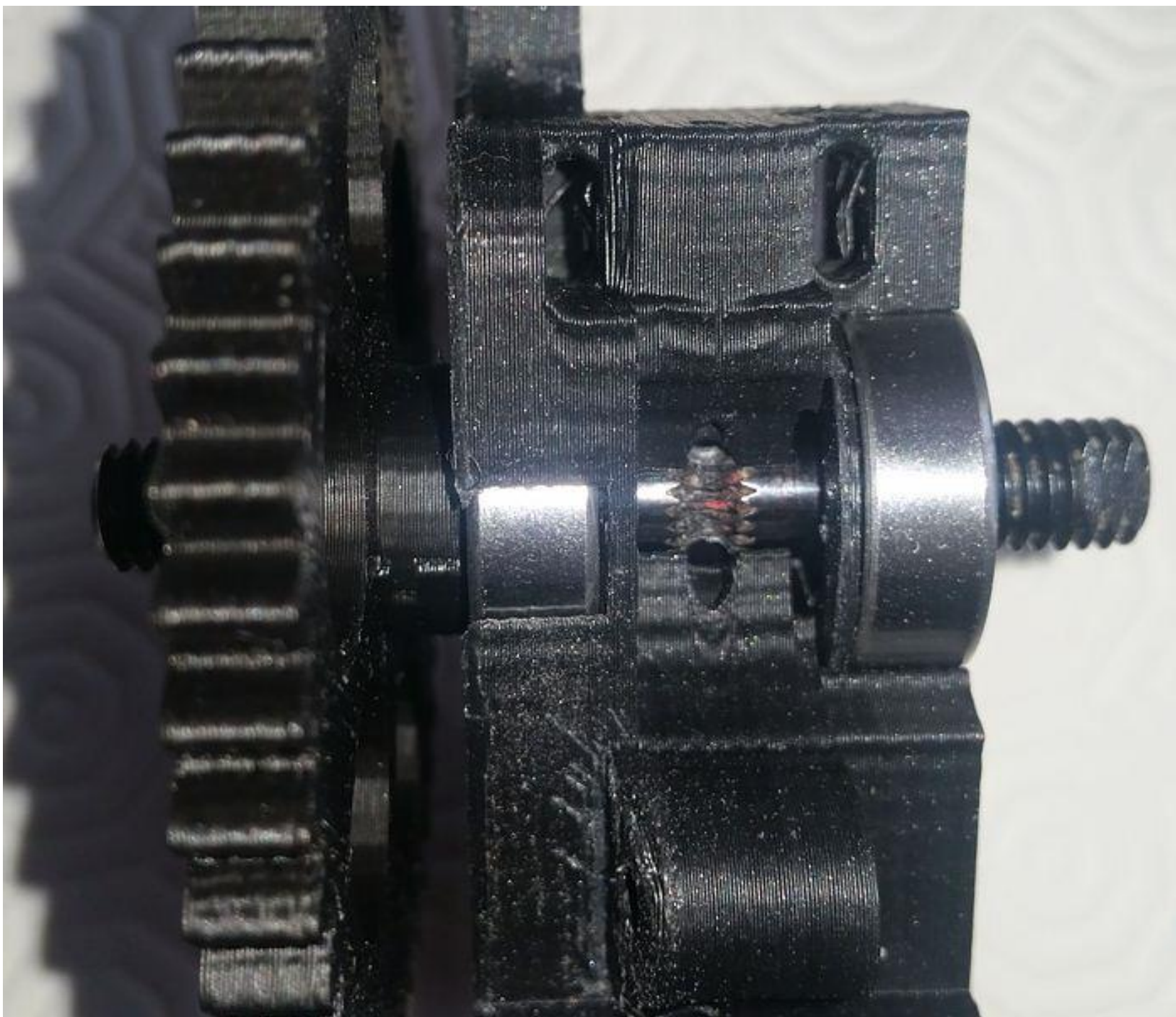
Insérer et visser la roue dentée sur la tige d'extrusion comme sur la photo.
