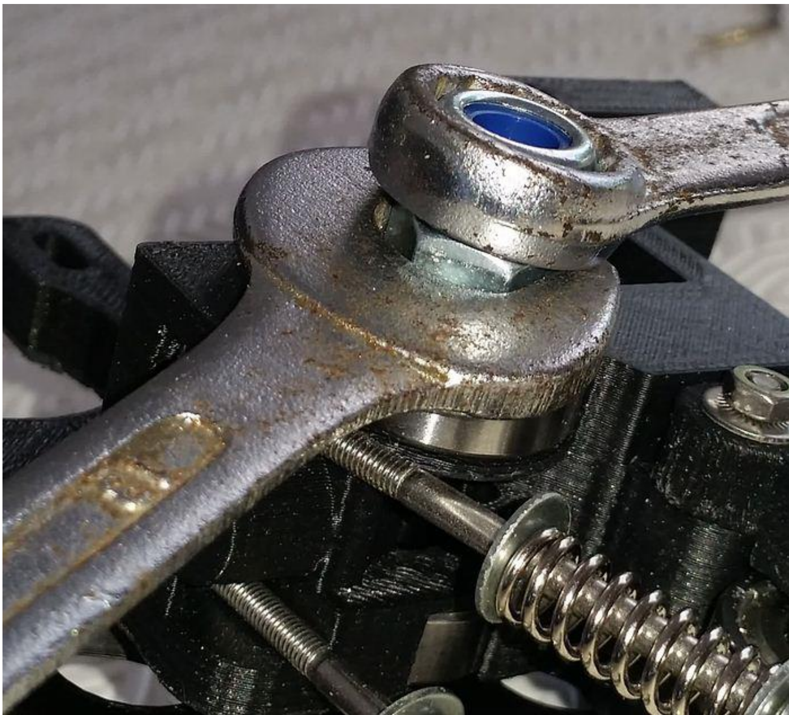
les 2 clef de 13 avec la clef plate qui tourne dans le sens anti horaire et celle a œil qui tourne dans le sens horaire.
